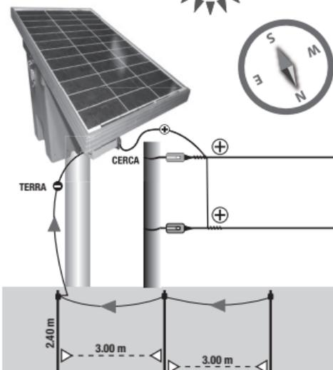
**INSTALE O PAINEL DIRECIONADO PARA O NORTE COM INCLINAÇÃO DE 20 GRAUS**
