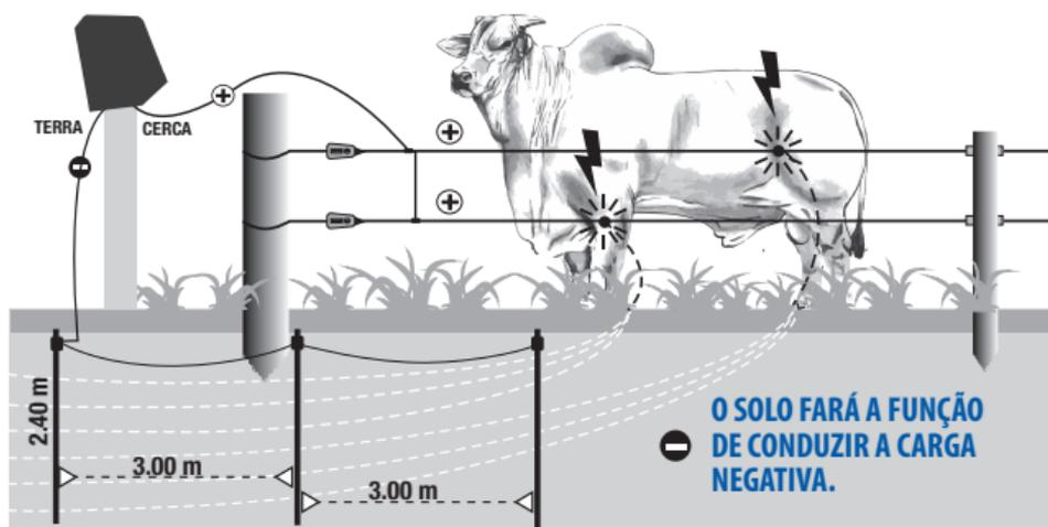
O animal recebe em seu corpo cargas negativas, emitidas pelo aterramento do Eletrificador Nellore, ao tocar na cerca com cargas positivas, fecha o circuito, resultando em uma forte sensação de choque.
