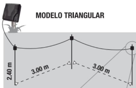
**IMPORTANTE:** As ligações entre as hastes devem ser com fio de cobre nu, com espessura mínima de 6mm, fixado nas hastes com conectores LS. Certifique-se que todas as ligações estão firmes e seguras.
