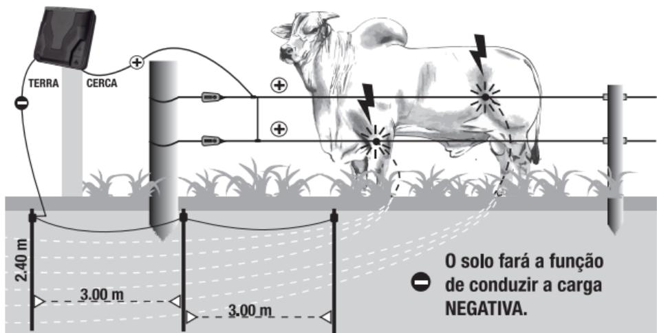
O animal, que terá em seu corpo cargas negativas emitidas pelo aterramento do Eletrificador Avant, ao tocar na cerca que possui cargas positivas, fechará o circuito, resultando em uma forte sensação de choque.
